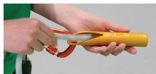
Brin de corde assureur qui rentre dans le tube par l'encoche en V en suivant l'indication Moulinette
