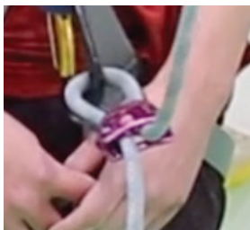
Système d'assurance avec mousqueton de sécurité
